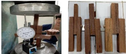
**Gambar 10. Proses Pengujian Dan Model Benda Uji**
