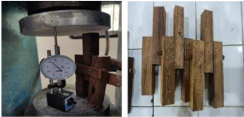
Gambar 10. Model benda uji dan proses pengujian
