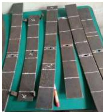
**Gambar 2.1.** Material Baja Karbon Menengah
