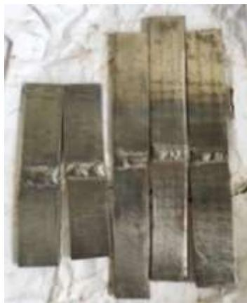
**Gambar 2.4.** Material yang dilas menggunakan pengelasan FCAW
