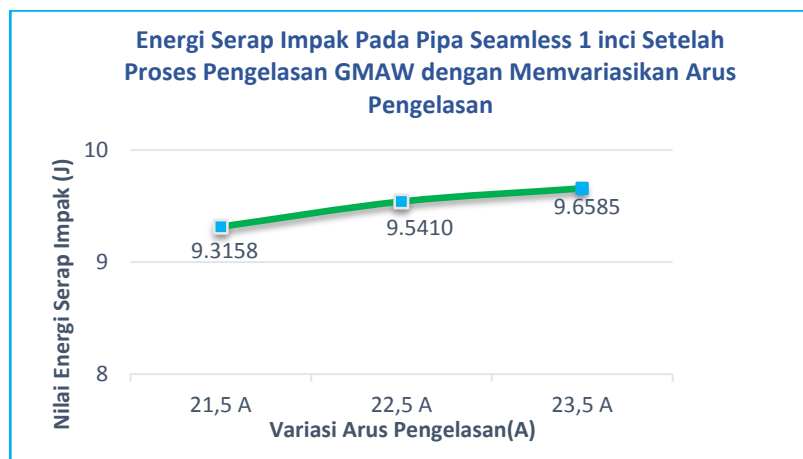
Gambar 4.1. Grafik Energi Serap Impact pada Pipa Seamless dengan Variasi Arus Pengelasan.
