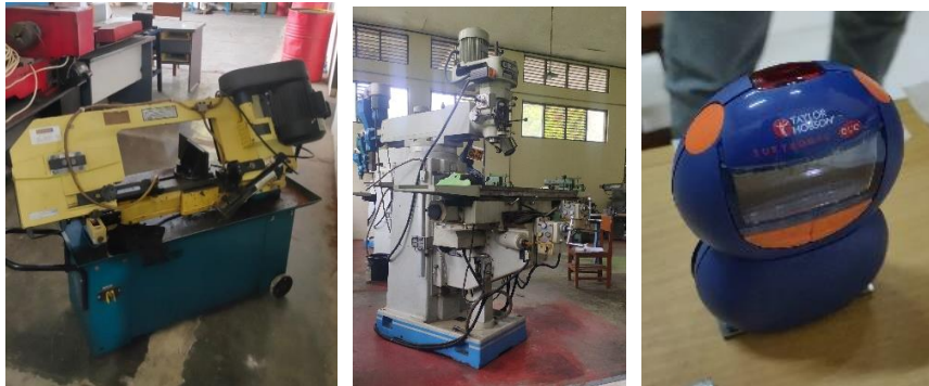
Gambar 3 Mesin pemotong besi, mesin frais dan alat uji kekasaran
