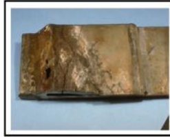
Gambar .2 Korosi tegangan pada logam
