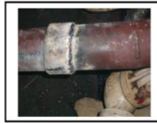
Gambar 1 Korosi Galvanic pada sambungan pipa
