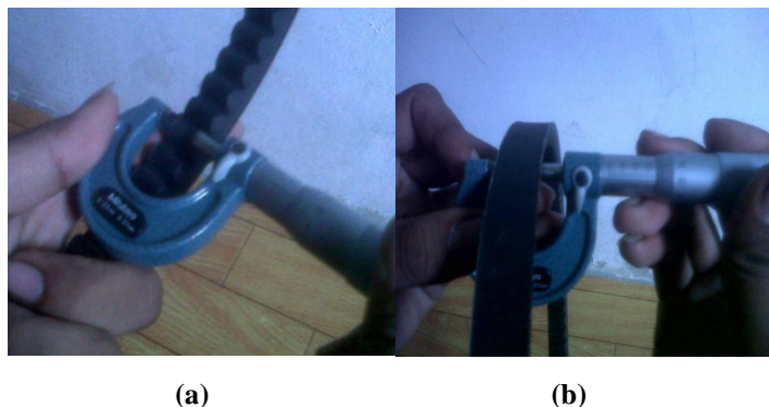
Gambar 6. (a) Pengukuran bagian bawah dan atas V-belt Standar (b) dan non-standar sebelum pengujian Sumber: Dokumentasi penelitian
