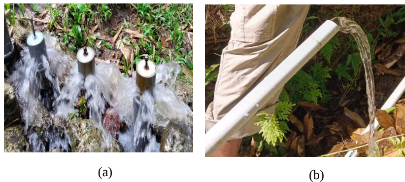
Gambar 7. Output debit air dengan variasi 3 katup buang (Sumber: Dokumentasi Penelitian)
