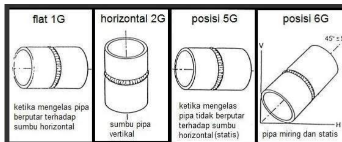
Gambar 2. Posisi pengelasan pada sambungan pipa
