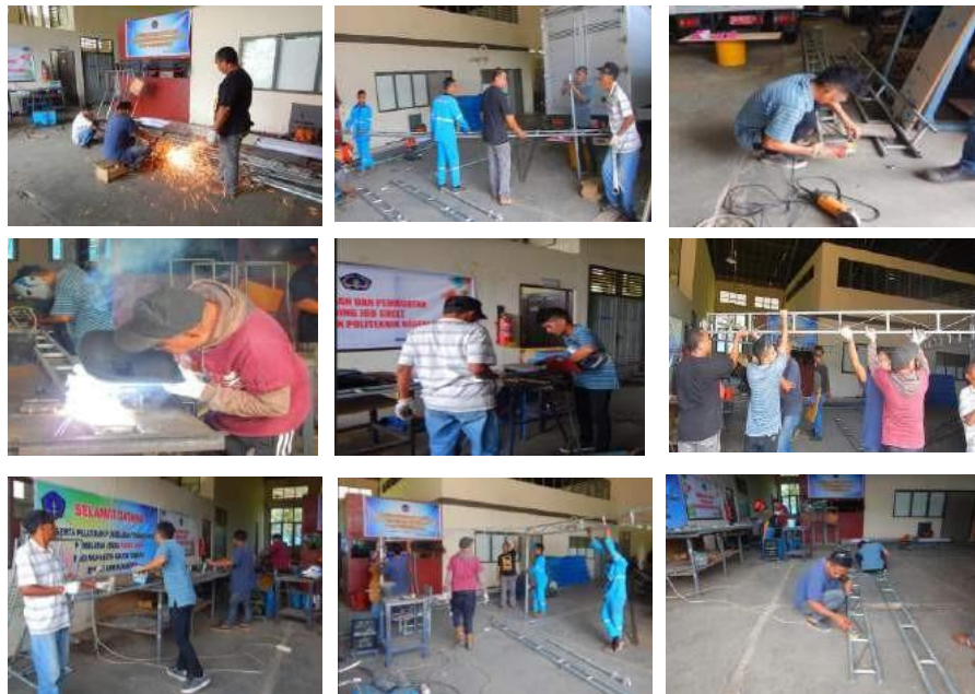
Gambar 7. Proses pemotongan, pengelasan dan perakitan pembuatan gelagar tengah, gelagar kiri/kanan, bagian kasau dan kaki tenda
