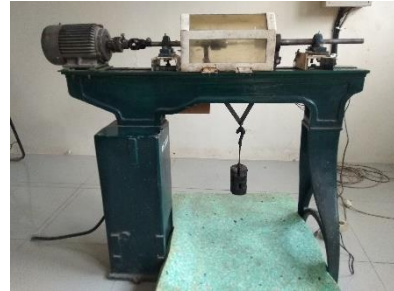
Gambar 2. Mesin Uji Bending
