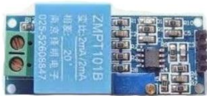
Gambar 2. 3 Sensor tegangan ZMPT101B
