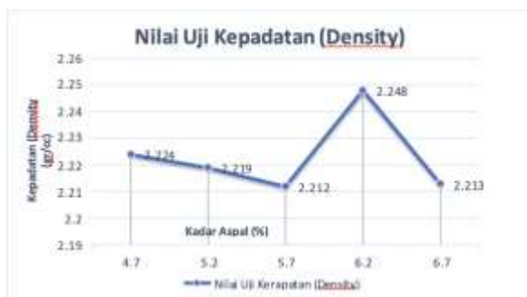
Gambar 4. Hubungan Kepadatan (Density) dan Kadar Aspal.
