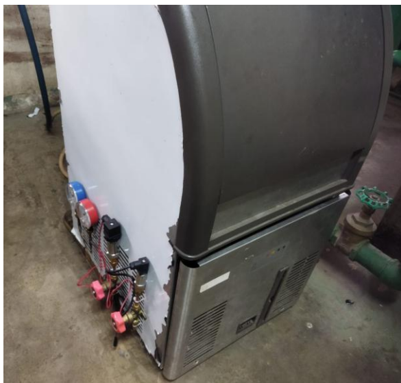
Gambar 4.1 integrasi pressure transmitter pada sistem
