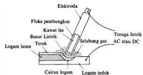
Gambar 1. Skema Pengelasan SMAW
