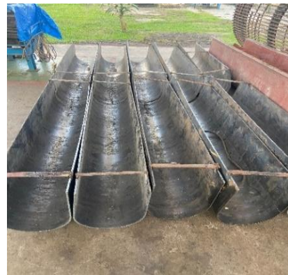
Gambar 6. Dudukan Screw hasil Press
