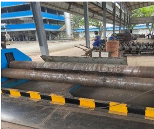
Gambar 4. Proses pembentukan flight screw dengan mesin press
