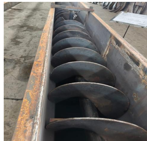
Gambar 9. Hasil perakitan Conveyor
